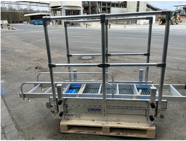
Podest mit Ballastgewicht für sicheren Einstieg
