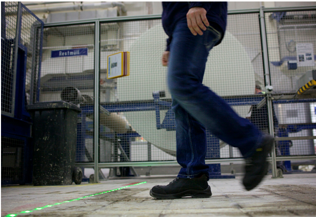
Verblüffend einfach: Die in den Boden eingelassenen LED-Leisten signalisieren deutlich, ob man gehen kann...
