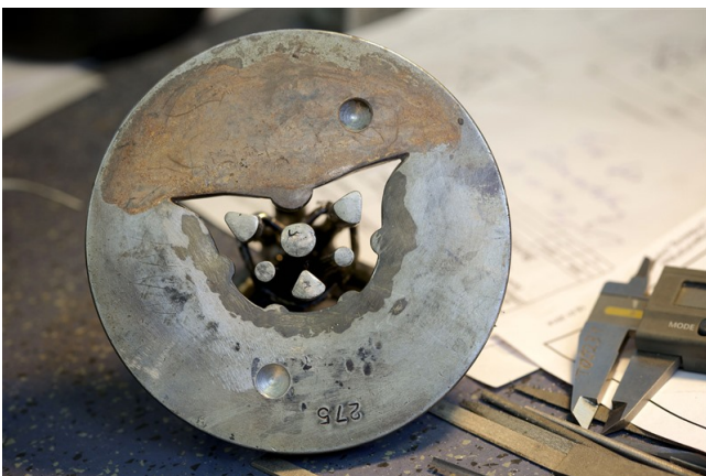
Extrusionswerkzeug für die Herstellung der Profile
