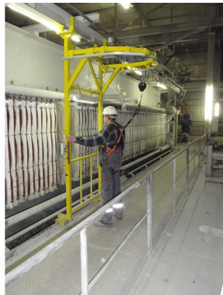
Abb. 7: Der gesamte Bereich ist gegen Zutritt durch Dritte gesperrt. Das Materialtor ist mit einem Schloss gesichert, die Zugänge zu den Pressen haben Kontaktschalter, die den Ablauf der Presse sofort unterbrechen.
