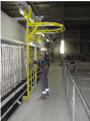
Abb. 7: Der gesamte Bereich ist gegen Zutritt durch Dritte gesperrt. Das Materialtor ist mit einem Schloss gesichert, die Zugänge zu den Pressen haben Kontaktschalter, die den Ablauf der Presse sofort unterbrechen.
