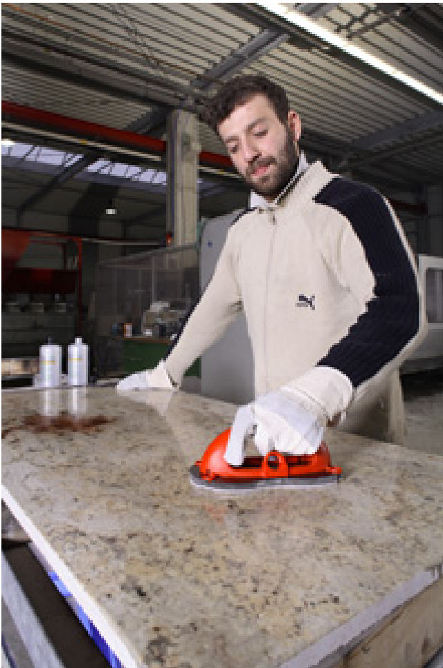
Auftrag des Oberflächenschutzes auf die Natursteinplatte
