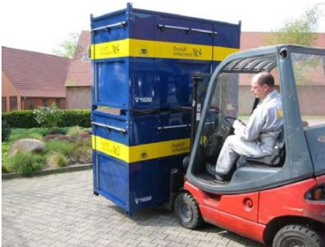
Container sind durch spezielle Halterungen stapelbar
